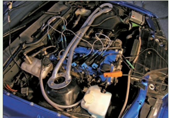
Bild 12: Allein um die Signale der Einzel-Zündspulen des BMW gleichzeitig abzugreifen, benötigt man bereits sechs Kanäle des Oszilloskops.
