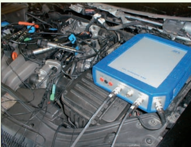
Bild 3: Das Zwölfkanal AVL DiScope 990 schickt alle Messwerte während der Testfahrt in einen Speicher und von hier auf den Bildschirm des angeschlossenen PCs oder Notebooks. Die Signale werden in einer Tastfrequenz von 1MHz verarbeitet und in informationsreiche Kurven umgewandelt. Die lückenlose Oszilloskop-Aufnahme lässt sich nach der Probefahrt aus dem Speicher auswerten.
