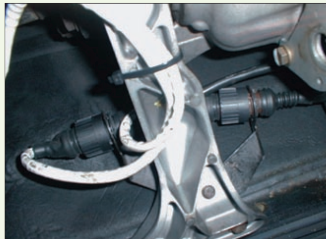
Bild 19: Die scheinbar verpolensicheren Lambdasondenstecker hatte ein Mechaniker versehentlich „ausgetrickst“, indem er die Lambdasonde der Zylinder 1, 2 und 3 mit der von Zylinder 4, 5 und 6 im Abgaskrümmer vertauscht hatte.
