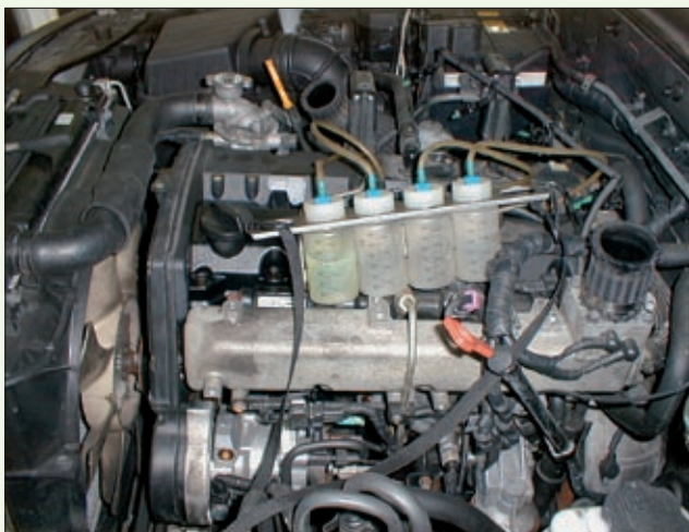
Bild 7: Die Rücklaufmengenmessung am Common-Rail zeigt deutlich, dass der Injektor von Zylinder 1 defekt ist.
