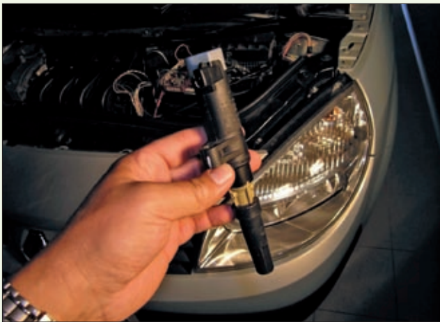
Bild 8: Mit diesem Zündmodul fuhr der Renault problemlos manchmal mehrere hundert, manchmal nur wenige Kilometer. Es verursachte einen Elektrosmog, der andere Fahrzeugsysteme störte und von der Eigendiagnose nicht erkannt wurde.
