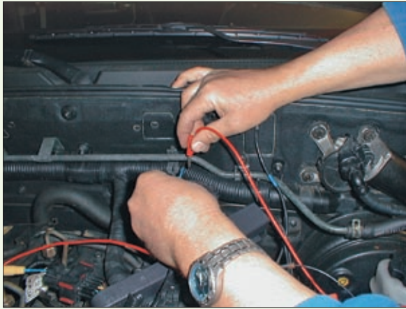
Bild 5: Dass das rote Signal in einer eigenen Frequenz, unabhängig von der Motordrehzahl schwankt, hat die Prüfung bewiesen, ...
